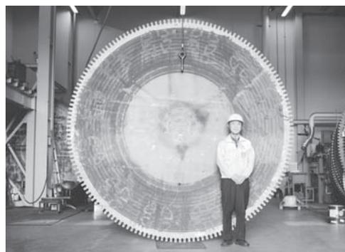
石材用ソーブレード（直径3m）
