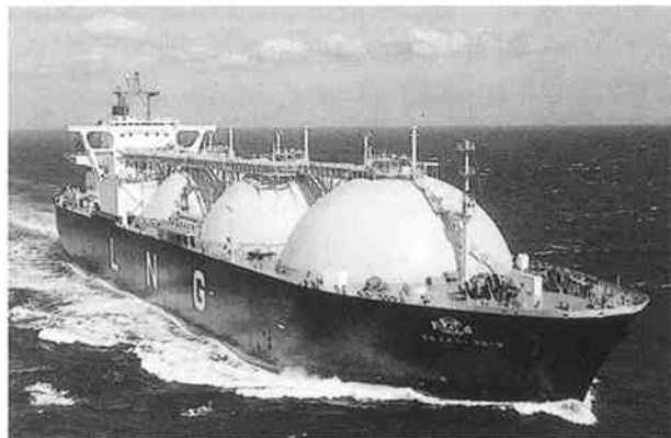
LNGは-162℃に冷却・液化することで体積を600分の1にして、専用タンカーで輸送
